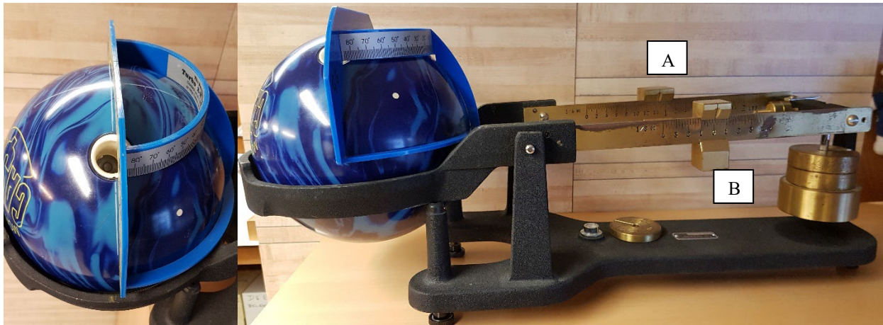
Schéma A : Centrage de la boule à l'aide du Pro Sect posé sur la protubérance du berceau et contre la boule du côté droit, puis du côté gauche.
